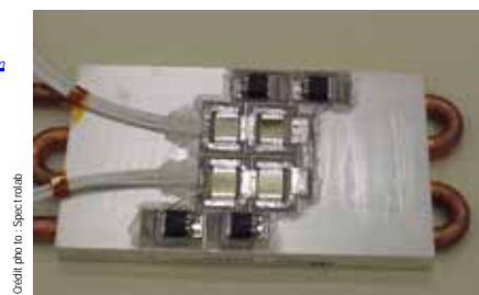
Cellule Spectrolab et son système de réfrigération
